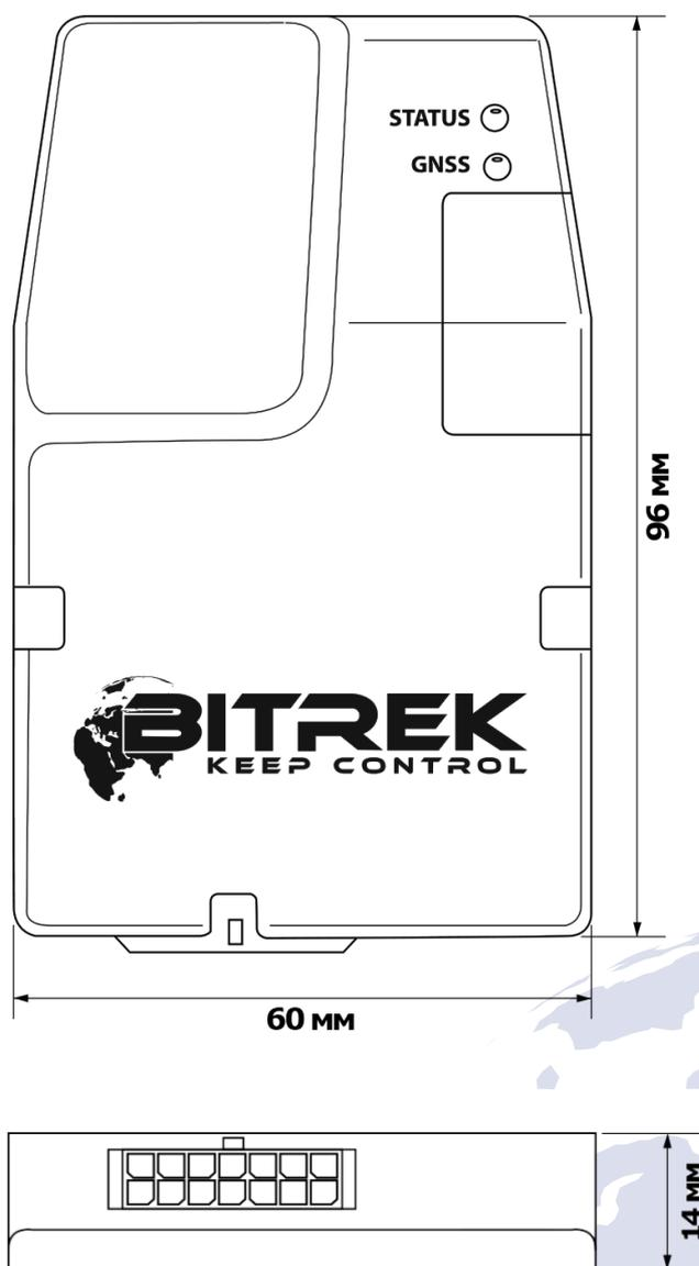
Рисунок 1 – Внешний вид и конструкция устройства.
