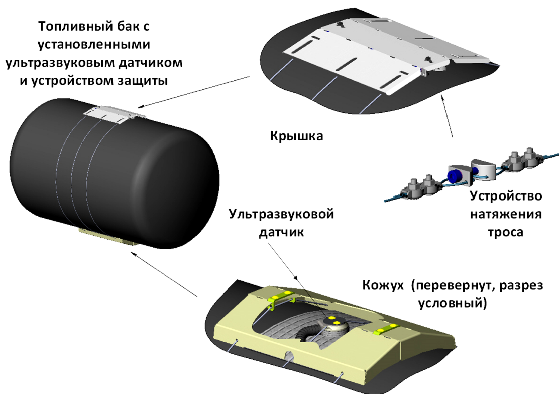
Рис 5.4 – Схема установки и расположения составных частей устройства защиты датчика (поставляется по запросу)
